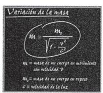
La masa de un cuerpo (o mejor dicho, la inercia) aumenta con su velocidad. Esto hace difícil que se pueda mover una nave espacial a velocidades próximas a las de la luz, porque su masa inerte sería muy grande.
